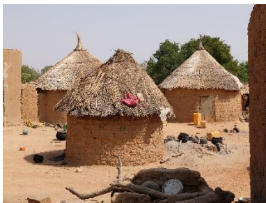
Les constructions à plan circulaire ont plus de résistance face au vent, elles ont une meilleure stabilité et se déforment moins facilement. De même, les constructions à faible hauteur résistent mieux aux vents (Région Centre-Ouest) – © Olivier Moles, CRAterre
