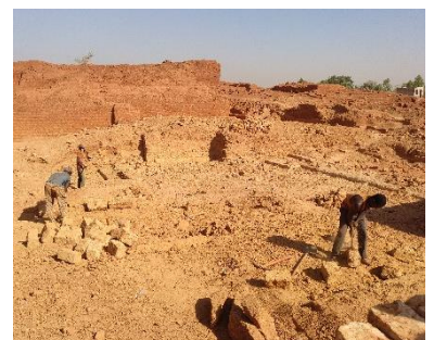
Carrière de Blocs Latéritiques Taillés (BLT), et d'autres produits à base de roche latéritique (Ouagadougou) – © Enrique Sevillano Gutiérrez - CRAterre
