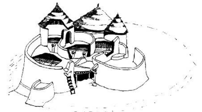
Concession Kassena construite sur une plateforme en terre – © Kéré, B., Guillaud, H., Boniface, X. (1995). Réf : Doat et al. (1991). Etude sur les savoirs constructifs au Burkina Faso ; Réf : Bourdieu, J. P. et al (1985). Designs for living in Upper Volta .
