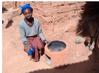
Foyer amélioré en banco. Ces foyers permettent de réduire la consommation de bois de chauffe, permettant ainsi aux femmes de passer moins de temps à la recherche de bois de chauffe. Ce type de foyer réduit aussi la fumée, améliorant ainsi la santé des femmes – CC Nitidae
