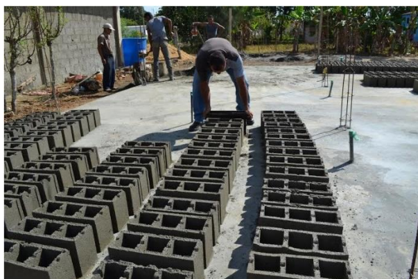
Elaboración artesanal de bloques de cemento-arena. Yaracruz. © PDVSA
