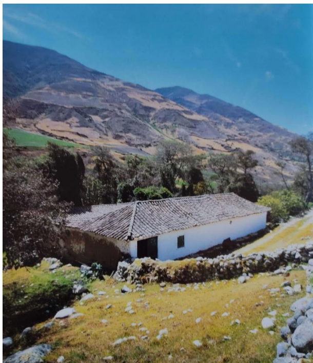
Casa de tapia encalada y con techos de teja, dispersa en terreno escarpado. Macuchíes, Estado de Mérida – Gasparini ©
