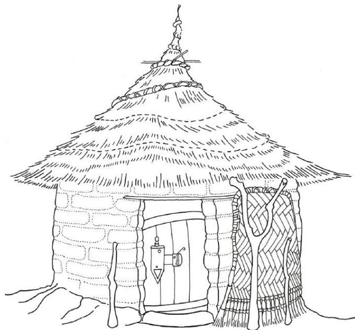
Vue d'une maison ronde (roguilga) avec des murs d'adobe et toiture conique en chaume (© María Lidón de Miguel)
