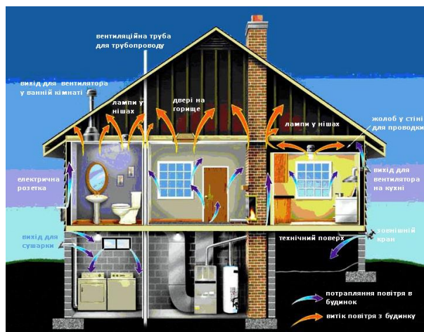
Рис. 33 - Класичне просочування повітря, що впливає на характеристики ізоляції
