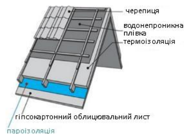
Рис. 28 - Принцип облицювання покрівлі з гідронепроникною плівкою під покрівлею
