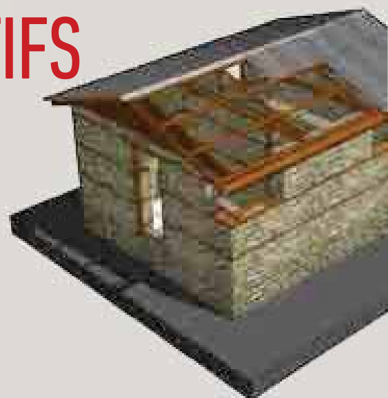
MODÈLE DE MAISON «TI'KAY» EN MAÇONNERIE DE PIERRE, module de base de 22 m 2 , 2 pièces sans perron
